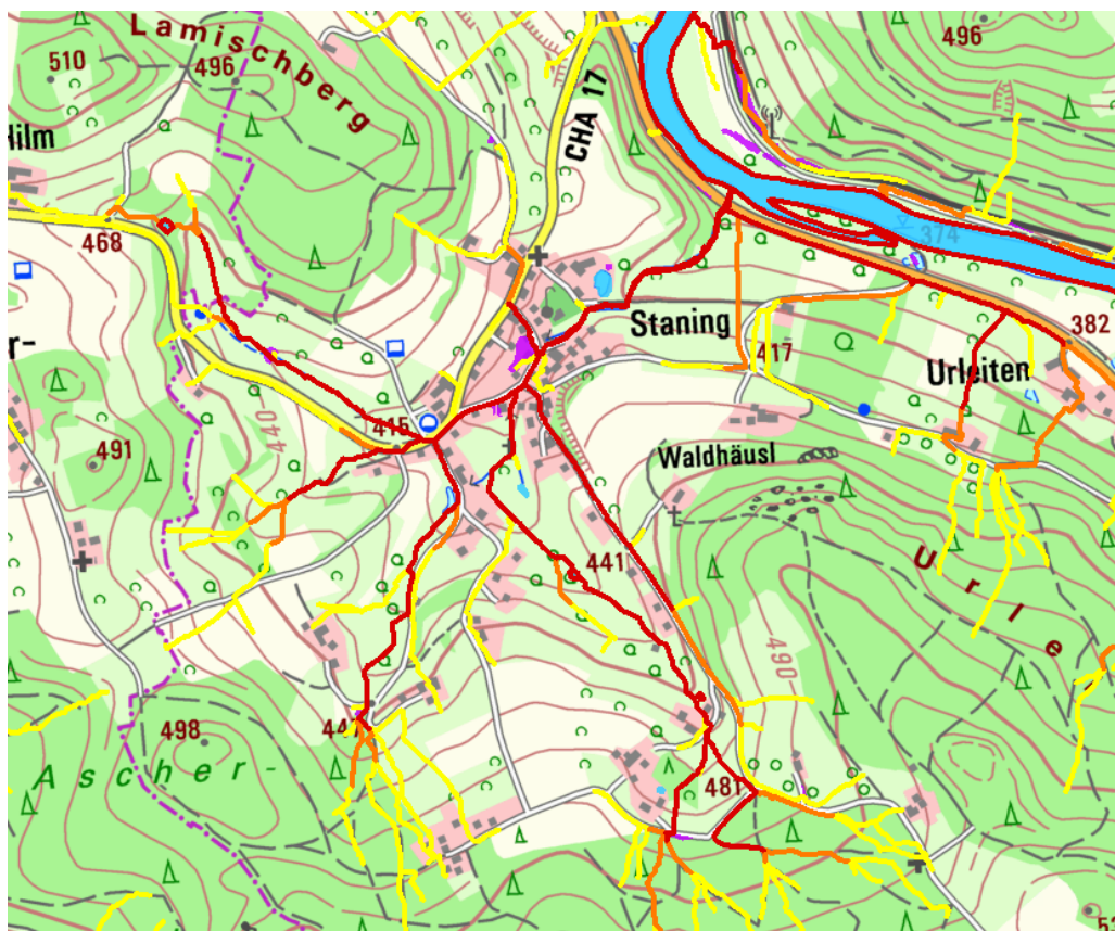
Abb.: potentielle Fließwege bei Starkregen (gelb- mäßiger Abfluss, orange- erhöhter Abfluss, rot- starker Abfluss)
