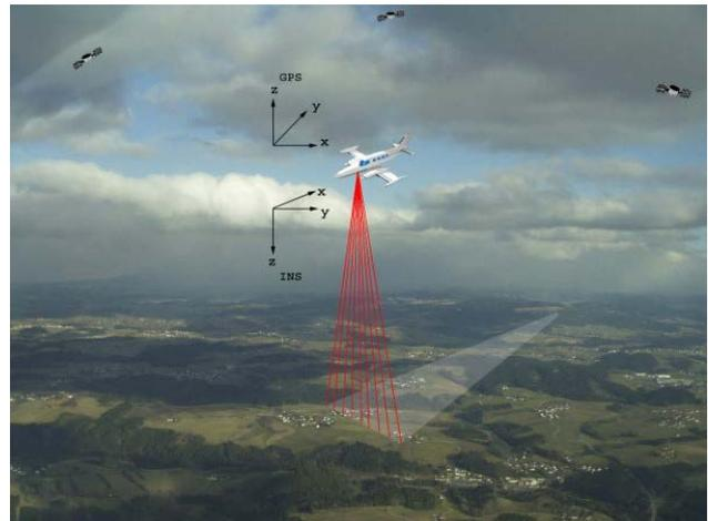
Abb. 2b: Prinzip des Laserscanning (Laufzeitmessung von Laserstrahlen)
