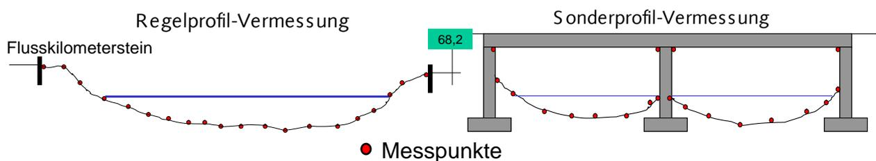
Abb. 3: Prinzip der Vermessung des Fluss- und Sonderprofils
